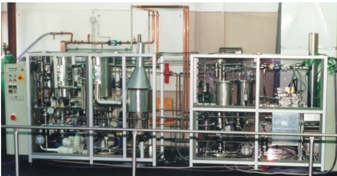
Bild 14: Laboraufbau einer PEM-Brennstoffzellen-Demonstrationsanlage zur Hausenergieversorgung (rechts Brennstoffzellenteil, links Reformerteil)
